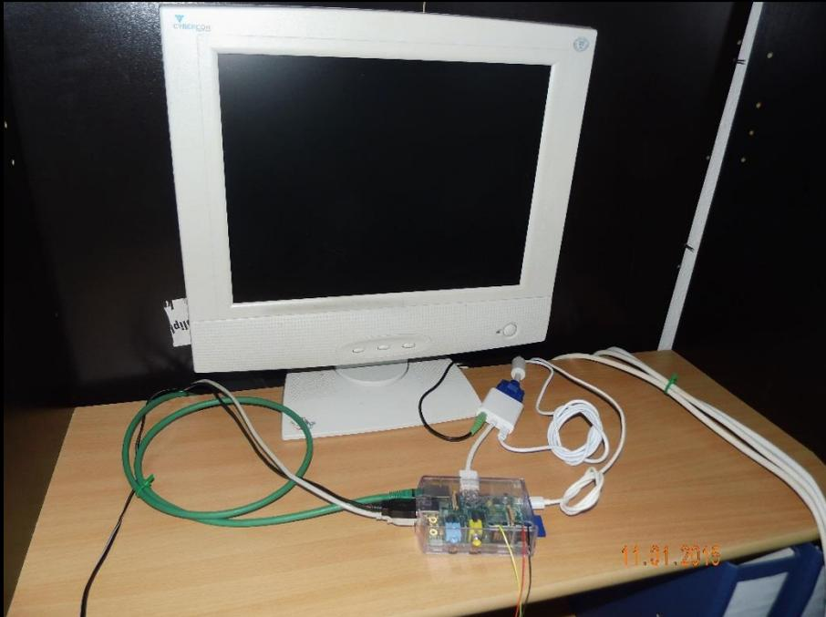
Der Raspberry ist über einen HDMI/VGA-Adapter an den schon ziemlich alten Bildschirm angeschlossen. Das dünne schwarze Kabel rechts unten holt 3V von einem Pin und das rote bzw. das gelbe Kabel geben die Spannung über einen Kippschalter wieder zurück auf zwei verschiedene GPIO Pins:
